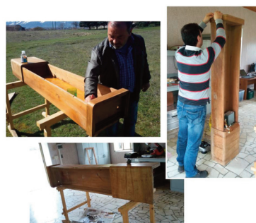
Figura 8 Fasi di sverniciatura, pulitura e ricostruzione di parti mancanti.
