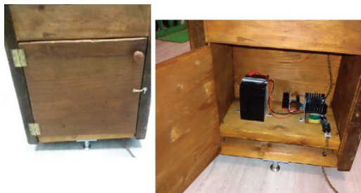
Figura 13 Sportellino posteriore e alimentatore alloggiato nella base del pendolo.
