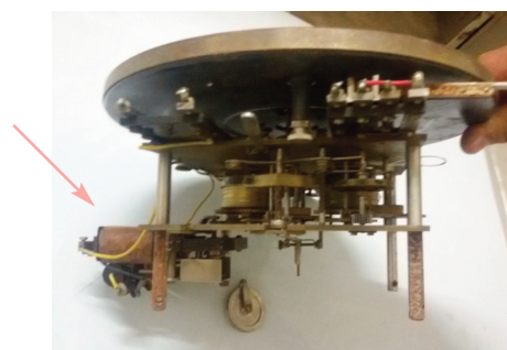
Figura 6 Vista laterale degli ingranaggi con evidenziato il motore elettrico di ricarica.
