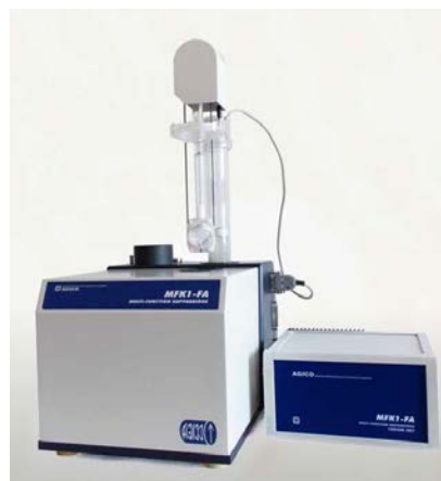
Figura 1 Il misuratore di suscettività magnetica impiegato in questo studio.
