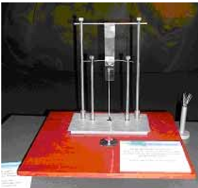
Figura 5 L'esperimento di Curie; la calamita si stacca dal filo di ferro quando diventa rovente.
