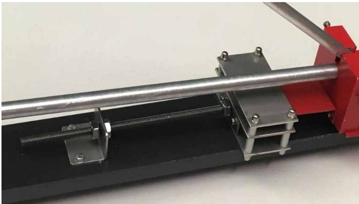
Figura 5 Dettaglio dello smorzatore e della sua regolazione realizzato dagli studenti.
