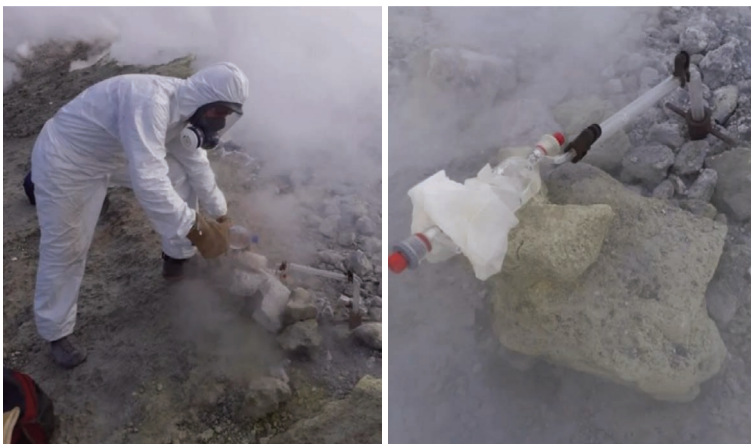
Figura 2 Campionamento di una fumarola sul Cratere de La Fossa di Vulcano (© Foto INGV - Fausto Grassa).
