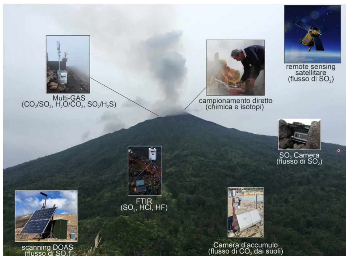
Figura 5 Una moderna rete strumentale per il monitoraggio geochimico dei vulcani attivi. Sullo sfondo, il vulcano Manam, in Papua Nuova Guinea (Foto: A. Aiuppa). Gli inserti mostrano le principali tecniche analitiche. (fra parentesi, i parametri monitorati) (Modificato da Aiuppa et al., [2025]).
