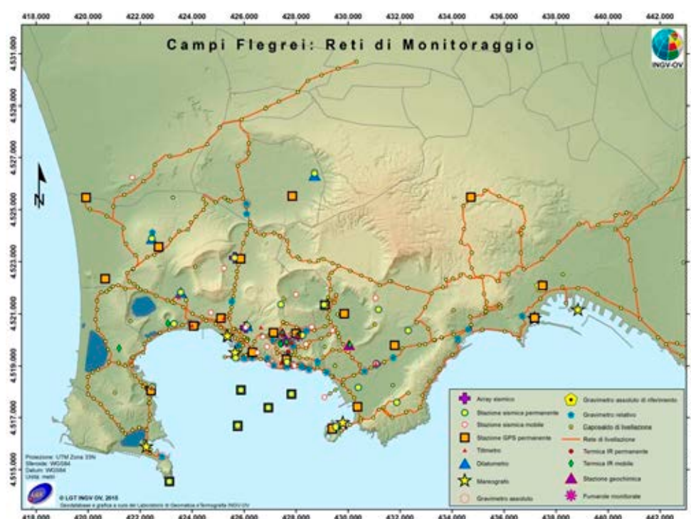
Figura 3 Reti di monitoraggio multiparametrico dei Campi Flegrei dell'INGV-Osservatorio Vesuviano.
