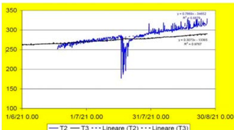
Figura 8 Registrazione automatica delle variazioni di temperatura ( ^\circ\text{C} ) nelle fumarole sull'orlo del versante Nord del cono La Fossa (dal Bollettino di monitoraggio geochimico isola di Vulcano, Agosto 2021).
