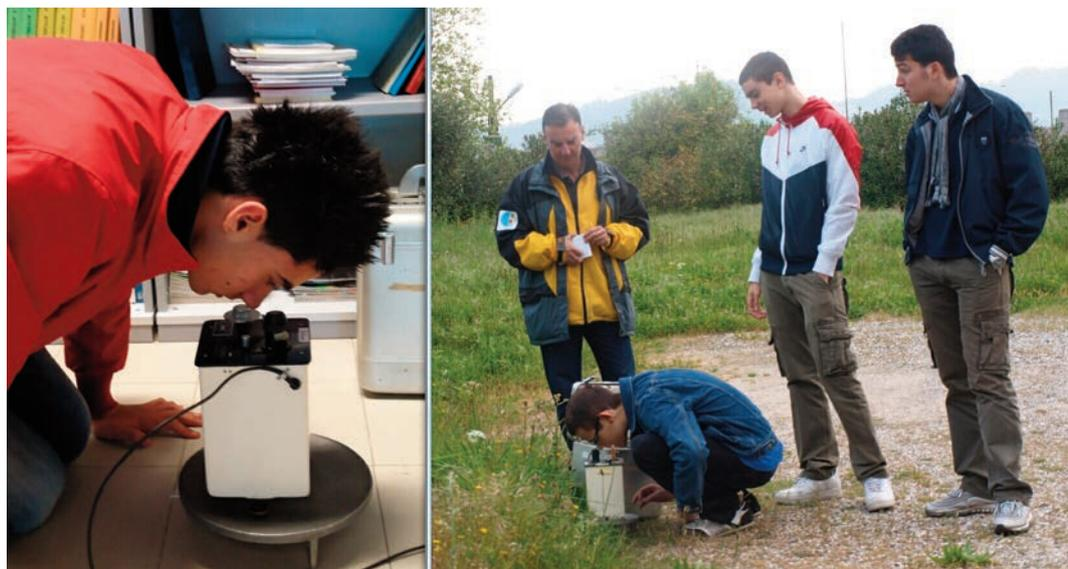
**Figura 3.** Misure del campo gravimetrico.
