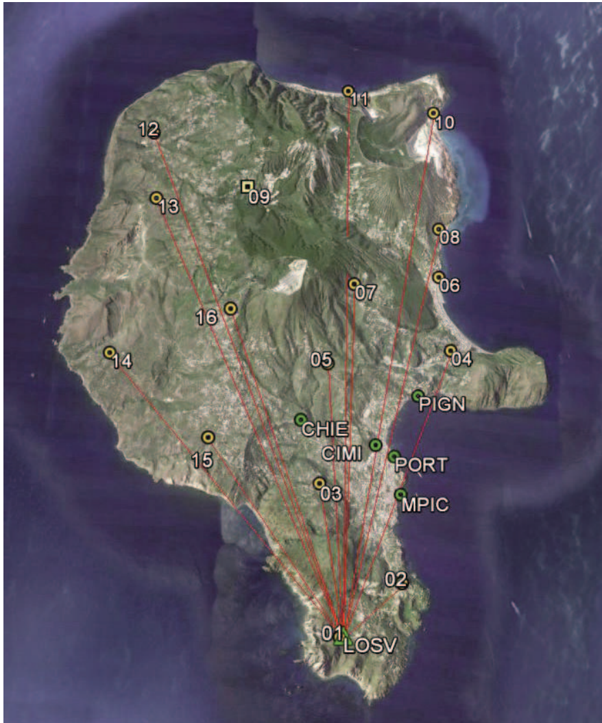
Figura 3. I GCPs misurati a Lipari. In verde sono indicati quelli misurati con tecnica GPS rapido statica per la zona intorno alla città di Lipari (campagna 2013). In giallo, quelli misurati con tecnica GPS/RTK alla scala dell'intera isola di Lipari (campagna 2014).
