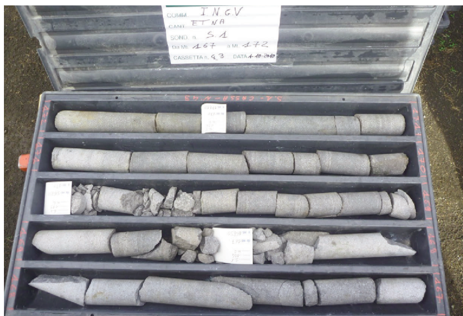
Figura 5 Cassetta con i campioni di roccia prelevati nella trivellazione di DRUV effettuata tramite carotaggio continuo (tecnica wire-line con prelievo della carota di materiale perforato). I campioni sono quelli incontrati tra -167 e -172 m, dove è stato posizionato e installato lo strumento in quanto in questo tratto la roccia presentava caratteristiche particolarmente uniformi e massive.
