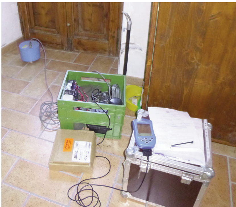
Figura 3 Strumentazione utilizzata per le misure di rumore sismico ambientale all'interno degli edifici.
