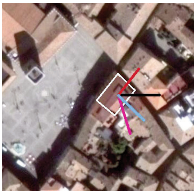
Figura 8 Identificazione del perimetro (bianco) dell'edificio dove è installata la stazione accelerometrica FANO. Linee colorate: direzioni dei picchi spettrali presentati in Figura 6. Nero: 90°N. Fucsia: 160°N. Rosso: 40°N (longitudinale). Blu: 130°N (trasversale). Figure 8 Identification of the perimeter (white) of the building where it is installed FANO accelerometric station. Colored lines: directions of the spectral peaks presented in Figure 6. Black: 90° N. Fuchsia: 160° N. Red: 40° N (longitudinal). Blue: 130° N (transverse).
