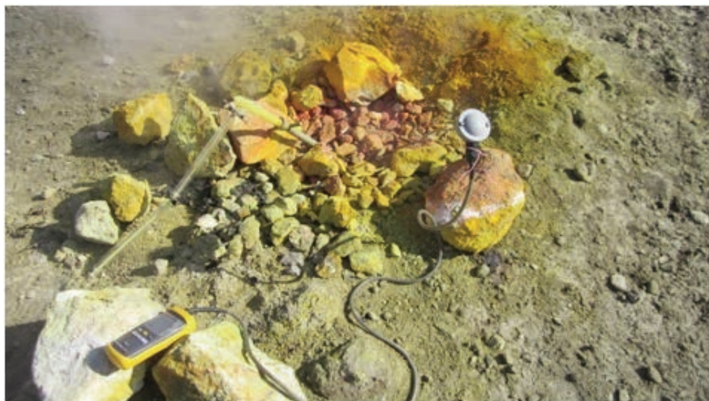
Figure 18 Bocca Nuova: temperature acquired using K-type thermocouple. Figura 18 Bocca Nuova; temperatura acquisita con termocoppia K-type.
