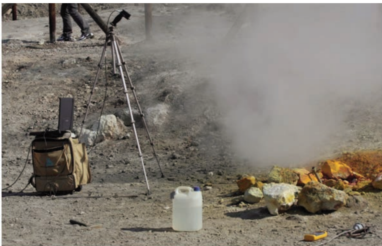
Figure 28 Radiance measurements collected with ASD-FieldSpec at Bocca Nuova. Figura 28 Misure di radianza acquisite con l'ASD-FieldSpec presso Bocca Nuova.
