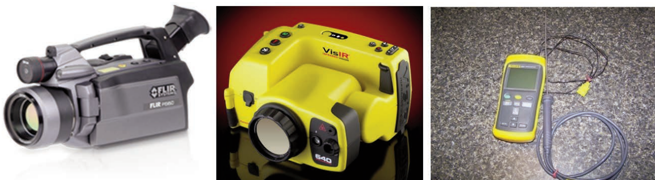
Figure 15 FLIR SC640, Thermotecnix VISIR640, Fluke 52 II with thermocouple of measurements K type (from left to right). Figura 15 Camere termiche: FLIR SC640, Thermotecnix VISIR640, Fluke 52 II con termocoppia di misure di tipo K (da sinistra a destra).
