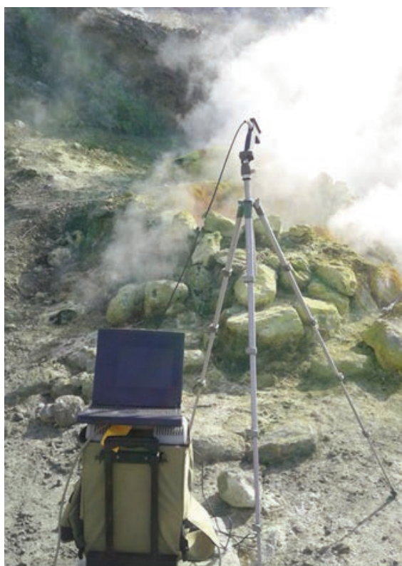
Figure 27 ASD-FieldSpec, radiance and reflectance measurement at Bocca Grande. Figura 27 Misure di radianza acquisite con l'ASD-FieldSpec presso Bocca Grande.
