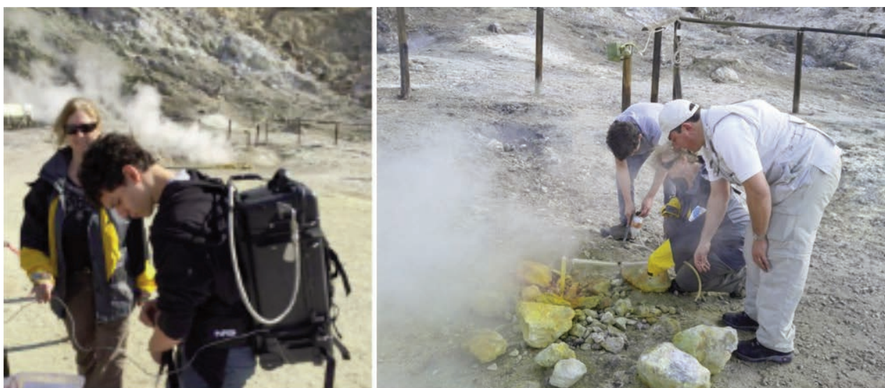
Figure 10 In situ Mass Spectrometer gas analysis at Bocca Nuova fumarole with UAV-MS-XPR3 ground test system in pack back configuration. Figura 10 Misure raccolte con lo spettrometro di Massa UAV-MS-XPR3 presso Bocca Nuova.
