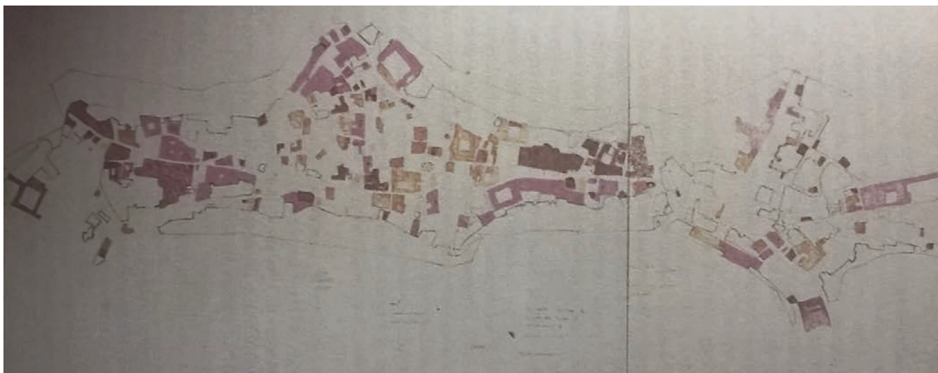
Figura 3 Terremoto del 28 luglio 1799: ricostruzione della distribuzione dei danni a Camerino. Da Capponi, [1992]. Figure 3 The earthquake of July 28 1799: damage distribution in Camerino. From Capponi, [1992].
