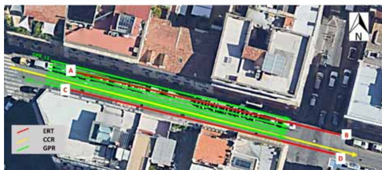
Figura 10 Immagine satellitare dell'area di intervento e profili geofisici effettuati (le linee in verde indicano le tracce GPR, la linea in giallo la traccia della geoelettrica capacitiva mentre le linee in rosso le tracce della tomografia elettrica tradizionale).
