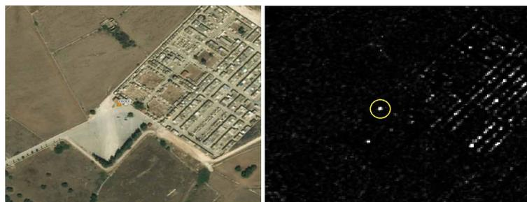
**Figura 14** Verifica della risposta del Corner Reflector installato a CROCE nelle immagini radar. La freccia gialla indica il pixel corrispondente al Corner Reflector.
