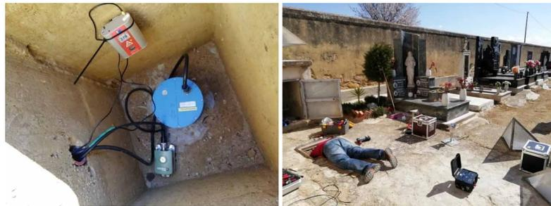
**Figura 10** Esempio di stazione multiparametrica: pozzetto con velocimetro, accelerometro e radonometro (a sinistra). Operazioni di sostituzione del sensore e installazione della stazione multiparametrica di ACATE nel marzo 2019 (a destra).
