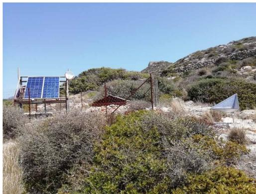
**Figura 12** Uno dei Corner Reflector (per SAR in banda X) già installato dall'ONT in Sicilia (a destra nella foto). La struttura è formata da una base di sostegno in acciaio inox e da un triedro in alluminio perforato, orientabile in funzione della traiettoria di passaggio del satellite.
