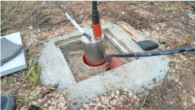
**Figura 6** Installazione del sensore Trillium Compact posthole in una perforazione di 10 metri presso Ragusa (ottobre 2018).
