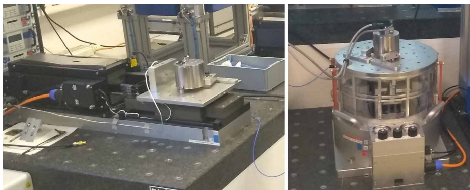
Figura 21 Set-up sperimentale in configurazione orizzontale sulla APS 129 (a sinistra) e in configurazione verticale sulla SE 13 (a destra).
