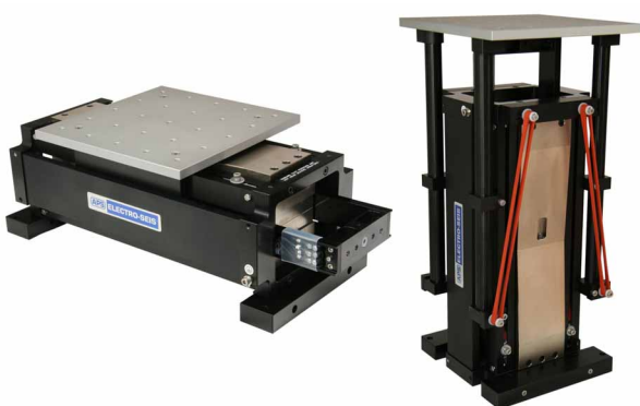
Figura 12 Tavola vibrante APS 420 in configurazione orizzontale a sinistra e verticale a destra.
