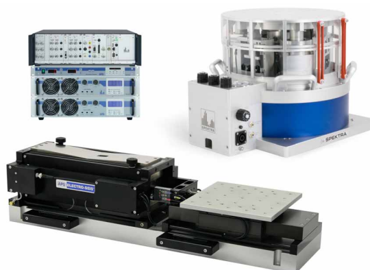
Figura 14 Componenti principali del CS18P, in alto a sinistra il sistema di controllo e gli amplificatori di potenza, in alto a destra la tavola vibrante verticale SE13, in basso la tavola vibrante orizzontale APS 129 ( https://www.spektra-dresden.com ).
