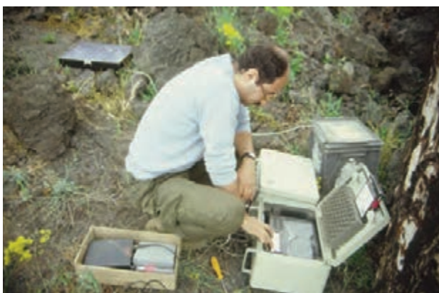
Figura 58 Operazioni di controllo su una stazione Lennartz PCM 5800 in registrazione locale (foto G. Vilardo).
