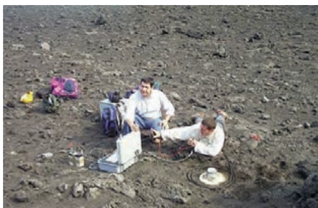
Figura 84 Installazione di un tiltmetro in acquisizione su una stazione Lennartz MARSlite in località Valle della Luna (foto M. Castellano). Figure 84 Installation of a Lennartz MARSlite seismic station equipped with a tiltmeter in the Valle della Luna site (photo M. Castellano).
