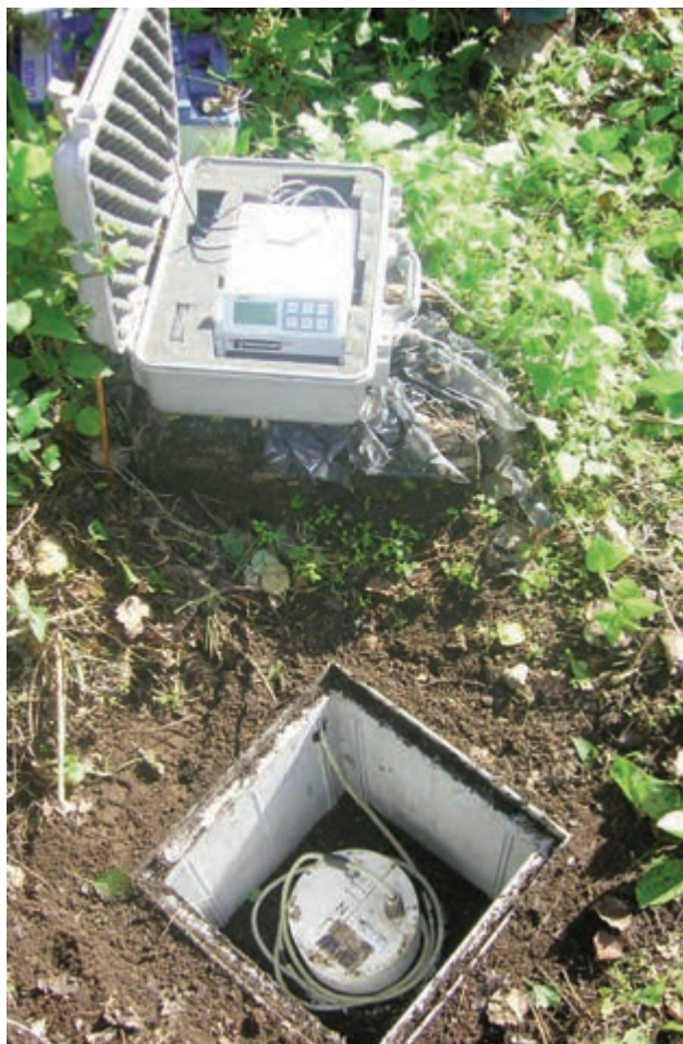
Figura 91 Stazione sismica ASB2 costituita da un acquirente Lennartz MARSlite ed un sismometro Lennartz LE-3D/20s installata all'interno dell'Oasi WWF degli Astroni fin dall'autunno 2004 (foto D. Galluzzo).
