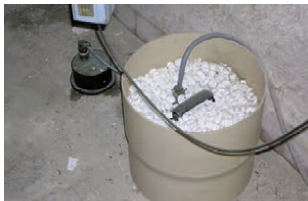
Figura 75 Sismometro Guralp CMG-40T (parzialmente coibentato) ed accelerometro Episensor ES-T installati presso la stazione di Trecase (foto D. Galluzzo).
