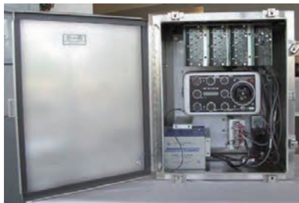
Figura 31 Sistema di acquisizione Reftek 130-MC a 18 canali ( www.reftek.com ). Figure 31 Eighteen channels Reftek 130-MC acquisition system ( www.reftek.com ).
