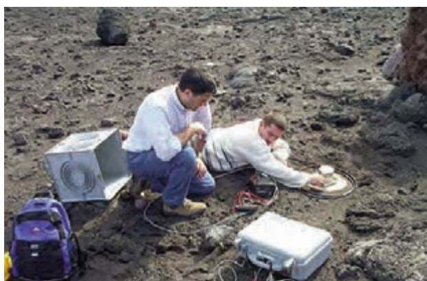
Figura 85 Come figura 84. Operazioni di verifica della messa in bolla del tiltmetro in acquisizione su una stazione Lennartz MARSlite (foto M. Castellano). Figure 85 As figure 84. Levelling of the tiltmeter acquired by a Lennartz MARSlite seismic station (photo M. Castellano).
