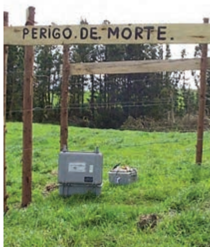
Figura 87 Stazione sismica Lennartz MARSlite e relativo sistema di protezione da atti vandalici! (foto M. La Rocca). Figure 87 Lennartz MARSlite seismic station and protection system for vandalism! (photo M. La Rocca).
