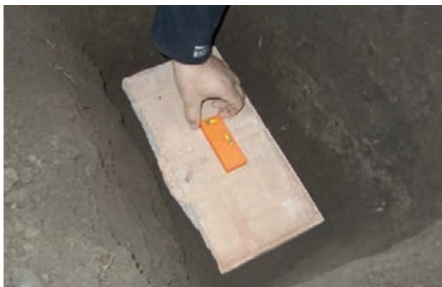
Figura 98 Predisposizione della base per il posizionamento del sismometro (foto D. Galluzzo). Figure 98 Arrangement of the seismometer basement in a vault (photo D. Galluzzo).
