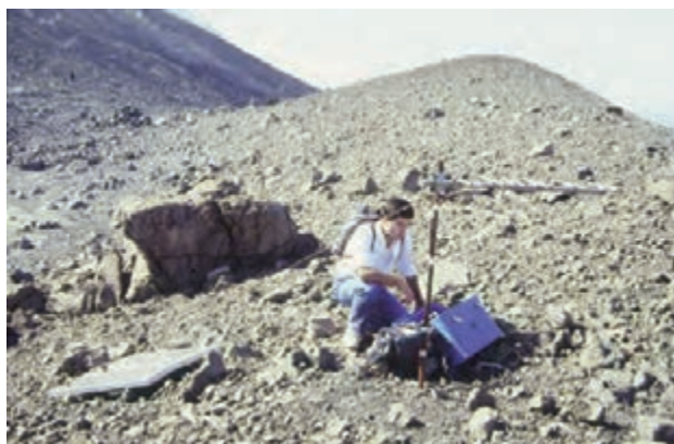
Figura 63 Controllo del funzionamento di una stazione Lennartz PCM 5800 in trasmissione installata a Vulcano (foto G. Vilardo).
