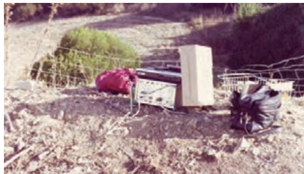
Figura 43 Stazione sismica Lennartz MARS-66 con registratore Philips D-6410 predisposta per la registrazione di uno degli scoppi durante la campagna in Sardegna (foto G. Milano). Figure 43 Lennartz MARS-66 seismic station equipped with Philips D-6410 cassette recorder during the Sardegna 1983 survey (photo G. Milano).
