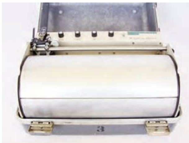
Figura 8 Esempio di registratore portatile a carta con scrittura ad inchiostro Portacorder Teledyne Geotech RV-320B ( http://s271.photobucket.com ).
