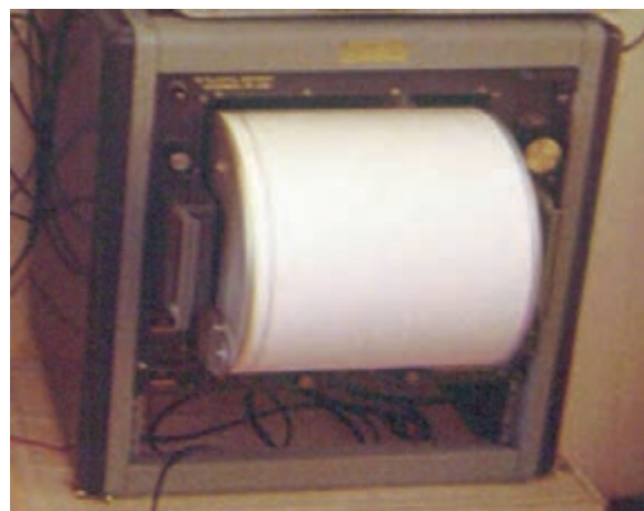
Figura 9 Registratore trasportabile a carta termosensibile Geotech Helicorder RV-301B (foto G. Vilardo).
