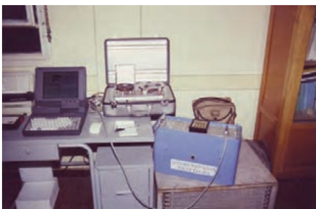
Figura 71 Catena di decodifica e sistema per l'elaborazione dei dati acquisiti dalle stazioni Lennartz PCM 5800 installato presso i laboratori del Servizio Geologico Egiziano (foto M. Castellano).
