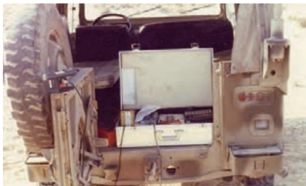
Figura 46 Stazione sismica, all'interno di una jeep dell'Esercito Tunisino, predisposta per la registrazione di uno degli scoppi (foto G. Milano).
