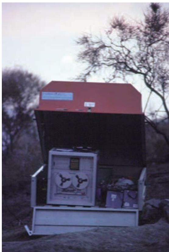
Figura 54 Sistema di acquisizione del cavo multicanale, costituito da un Encoder PCM 5800 a 15 canali e registratore Nagra a nastro magnetico (foto G. Vilardo).
