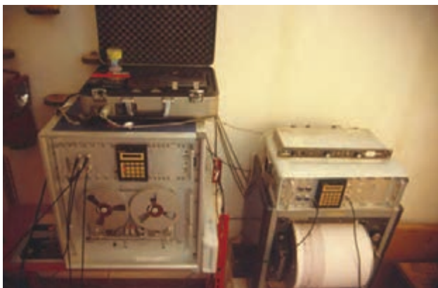
Figura 59 Sistema di acquisizione installato in località San Gregorio (CT). Si nota l'unità Mixer ed una stazione collegata al registratore UHER Report Monitor 4400 . In basso a destra è visibile il registratore a carta Helicorder RV-310 (foto G. Vilardo). Figure 59 Acquisition system installed at San Gregorio (CT). Note the Mixer unit and a seismic station with the UHER Report Monitor 4400 tape recorder. In the lower right corner the thermal paper monitor Helicorder RV-310 is visible (photo G. Vilardo).
