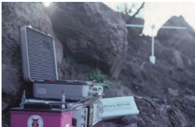
Figura 53 Stazione sismica Lennartz PCM 5800 installata sull'Isola di Vulcano. Sullo sfondo l'antenna loop per la ricezione del segnale del tempo DCF77 (foto G. Vilardo).
