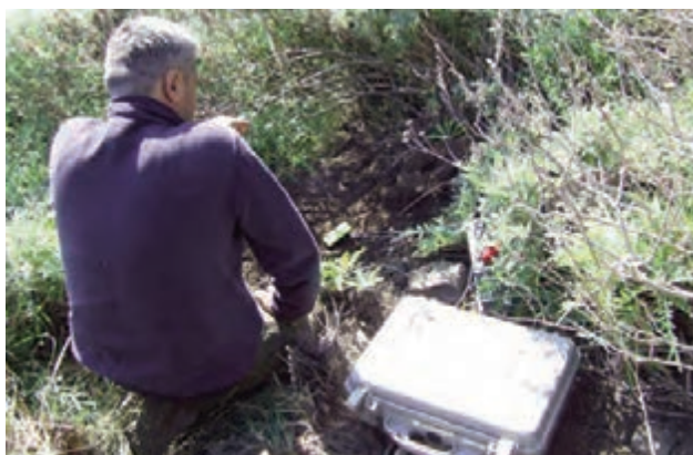
Figura 102 Posizionamento mediante GPS portatile Garmin ® di una stazione sismica durante l'esperimento di Tomografia (foto M. Castellano).
