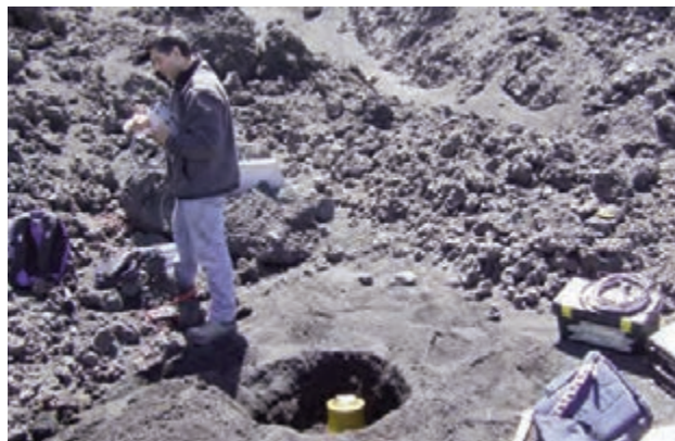
Figura 109 Installazione di una stazione multi-sensore basata su un acquirente Lennartz M24 a 6 canali in prossimità di Punta Lucia (foto M. Castellano). Figure 109 Six channels multi-sensors Lennartz M24 installed at Punta Lucia site (photo M. Castellano).
