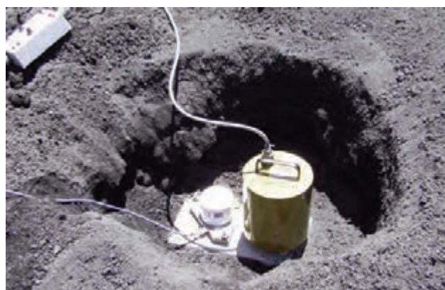
Figura 110 Sismometro Geotech KS-2000 e tiltmetro Applied Geomechanics posizionati su due mattonelle di cemento all'interno di una buca scavata nelle vulcaniti (foto M. Castellano). Figure 110 Geotech KS-2000 seismometer and Applied Geomechanics tiltmeter siting in an appropriate vault buried in volcanic material (photo M. Castellano).
