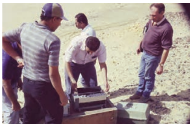
Figura 70 Sostituzione del rullo a carta affumicata del registratore Spregnether MEW-800 in dotazione al Servizio Geologico Egiziano (foto M. Castellano).
