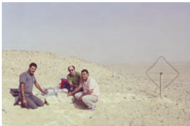
Figura 69 Installazione di una stazione Lennartz PCM 5800 in pieno deserto a sud del Cairo. Sulla destra è visibile l'antenna loop per la ricezione del segnale del tempo DCF77 (foto G. Milano).
