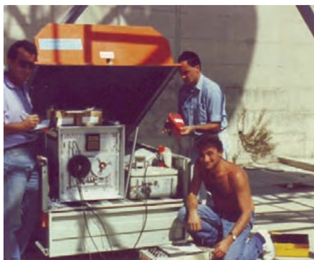
Figura 67 Installazione del sistema di acquisizione a Mt. S. Angelo (Lipari) costituito da un'unità Lennartz Mixer PCM 5800 e registratore Nagra a nastro magnetico all'interno di un carrello trasportabile (foto V. D'Errico). Figure 67 Acquisition system installation at Mt. S. Angelo (Lipari). A Mixer Lennartz PCM 5800 unit with Nagra tape recorder is mounted within a car trailer (photo V. D'Errico).
