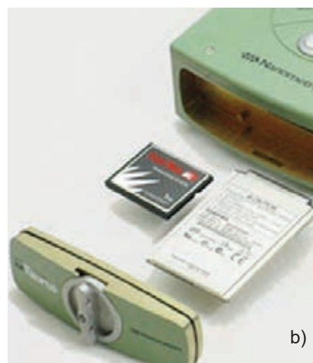
Figura 27 a) Stazione sismica Nanometrics Taurus ( www.nanometrics.ca ) con display LCD a colori e keypad a cinque tasti. b) Supporti di memorizzazione ( compact flash e disco ATA). Figure 27 a) Nanometrics Taurus seismic station ( www.nanometrics.ca ) with LCD color display and five button keypad. b) Internal data storage ( compact flash and ATA disk).
