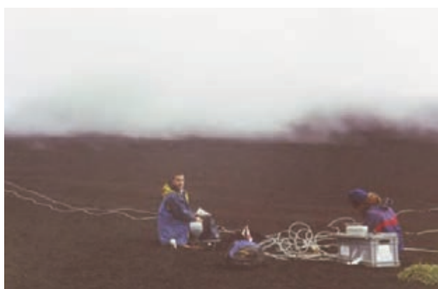
Figura 77 Installazione del sistema di acquisizione dell' array in località Piano delle Concazze (foto M. Castellano).
