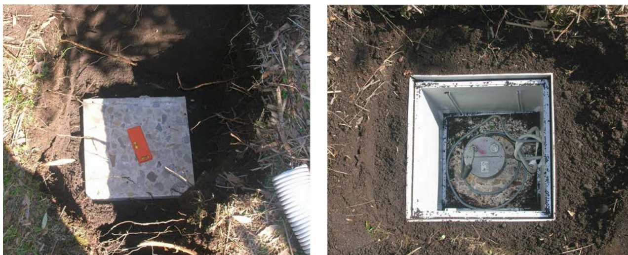
Figura 2 Due fasi della installazione dei sismometri. 1) posizionamento della base in fondo alla buca; 2) posizionamento del pozzetto sopra la base, livellamento e orientamento del sismometro. Figure 2 Two phases of the seismometers installation. 1) Leveling of the thick tile at the bottom of a hole; 2) leveling and orientation of the three-component seismometer inside a plastic case.
