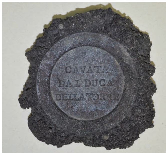
Figura 3 Esempio dell'effetto della compressione delle matrici sulla lava. La porzione compressa dalla matrice ha un aspetto compatto, mentre la parte esterna rimane scoriacea.
