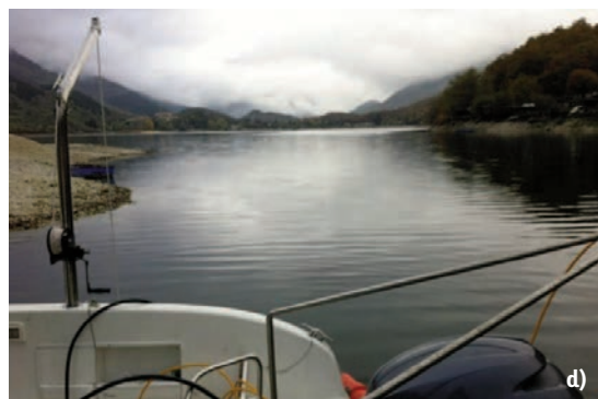
Figura 5 Il BigOne a) Trasporto imbarcazione dalla darsena di La Spezia; b) Allestimento per l'acquisizione; c) Ormeggio al Lago di Scanno e posizionamento del magnetometro in acqua; d) Vista del verricello per traino SSS e magnetometro.
