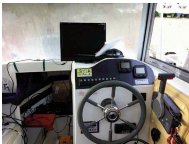
Figura 20 Sistema di navigazione e acquisizione dati magnetici. Figure 20 Navigation and magnetic data acquisition system.
