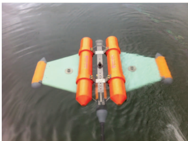
Figura 19 Magnetogradiometro SeaQuest con sistema di galleggiamento. Sono visibili 2 sensori, mentre il terzo rimane sotto la superficie dell'acqua.
