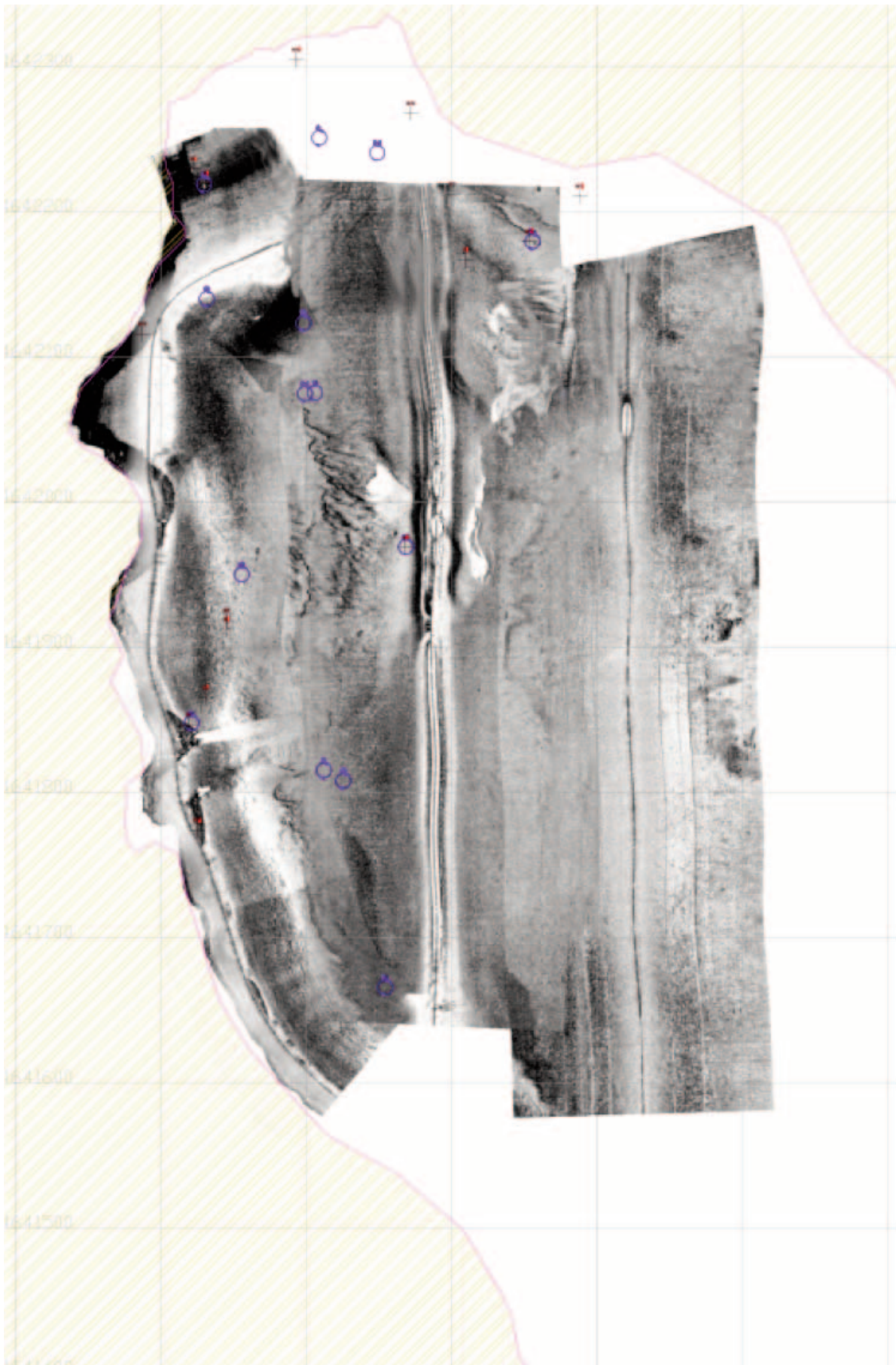
Figura 26 Ricostruzione da SSS del fondo del Lago di Scanno. I target identificati sono riportati in blu. Figure 26 SSS reconstruction of the depth of Scanno Lake. The identified targets are shown in blue.
