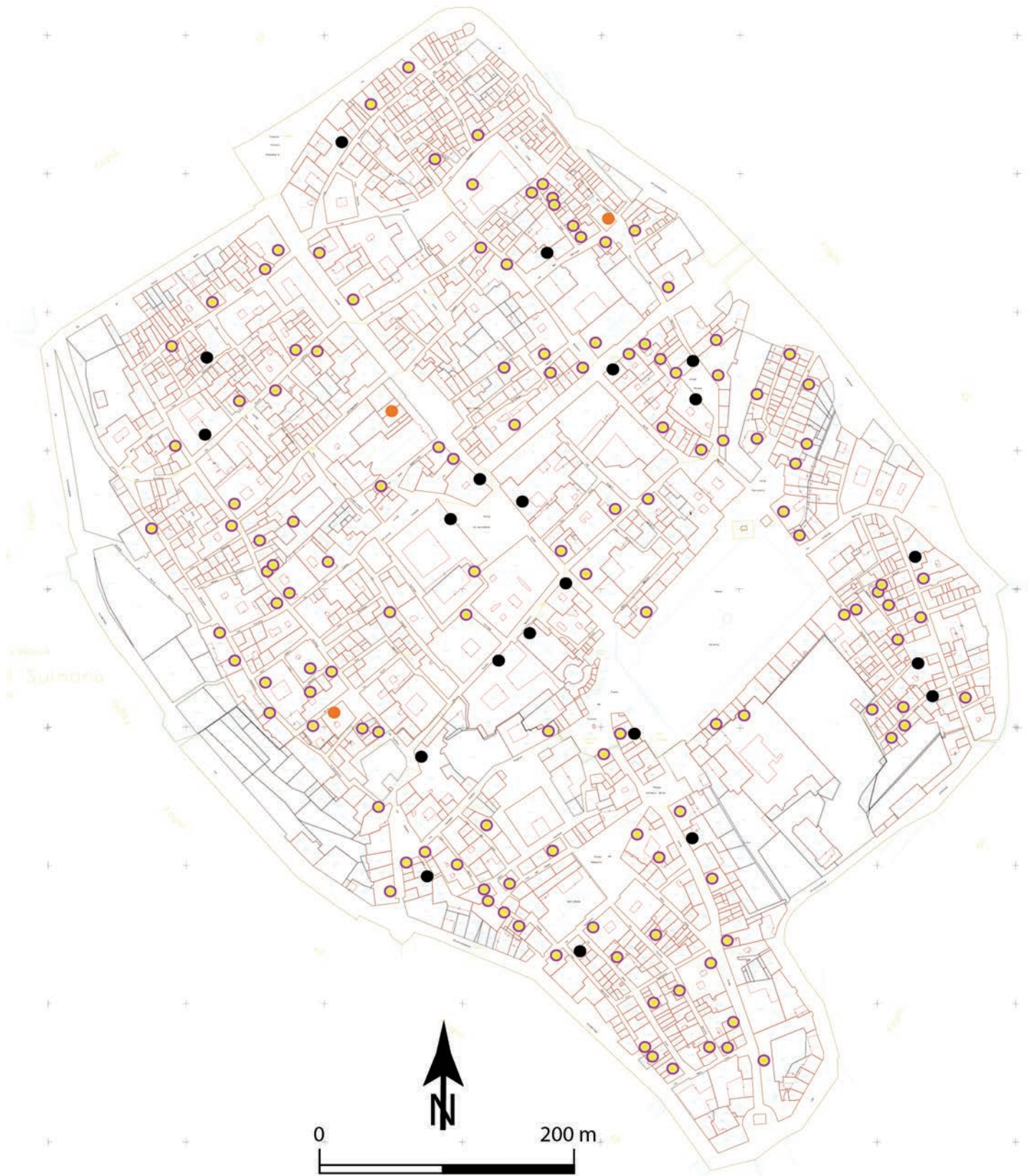
Figura 17 Edifici del centro storico che hanno subito danni a causa di più terremoti della serie 1915, 1933, 1984, 2009 (in giallo i punti di danno riferibili a due terremoti; in nero i punti riferibili a tre terremoti; in arancio i punti riferibili a quattro terremoti).
