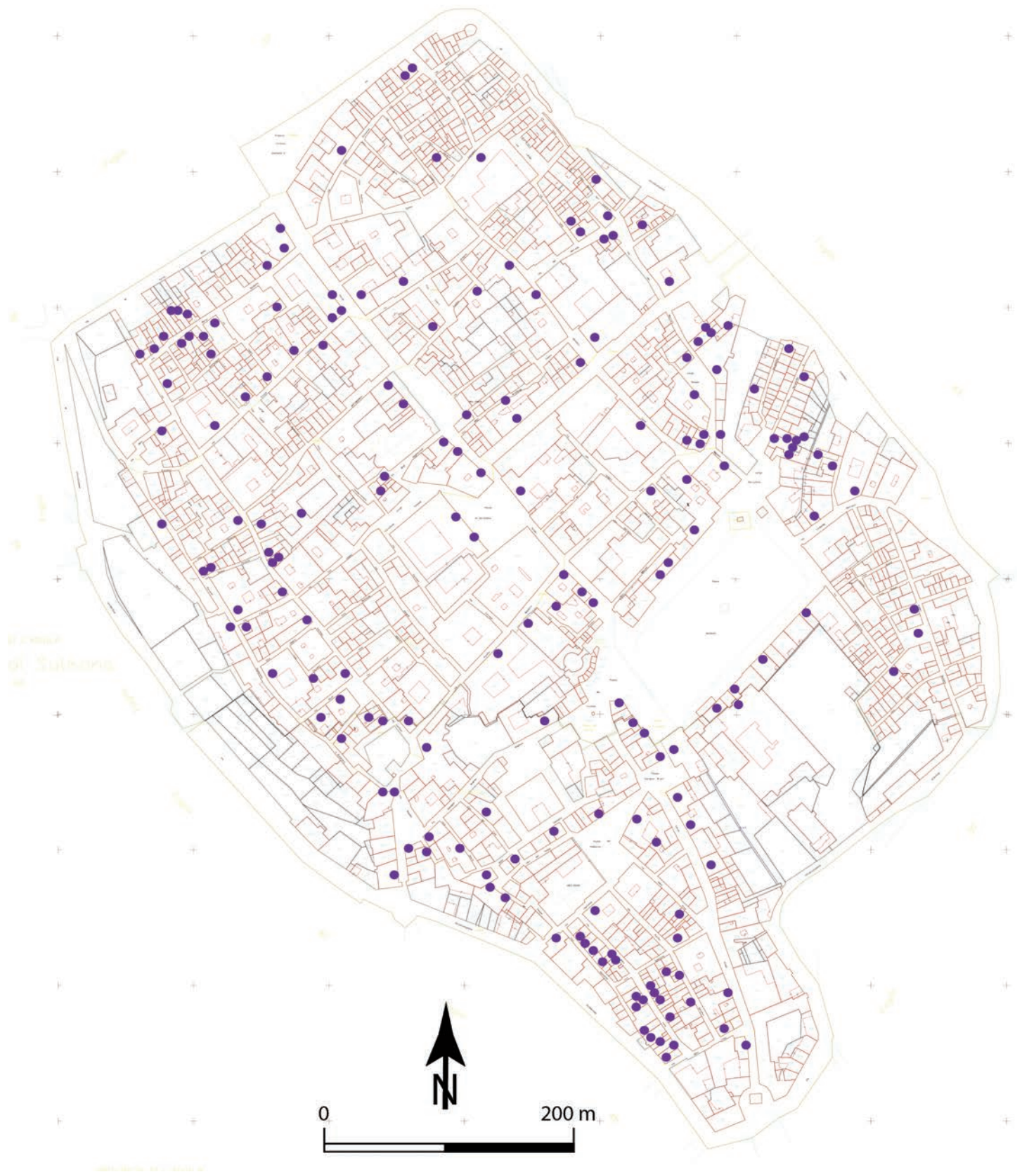
Figura 12 Distribuzione del danno nel centro storico di Sulmona: terremoto del 1915. Figure 12 Damage distribution in the old town centre of Sulmona, due to the 1915 earthquake.
