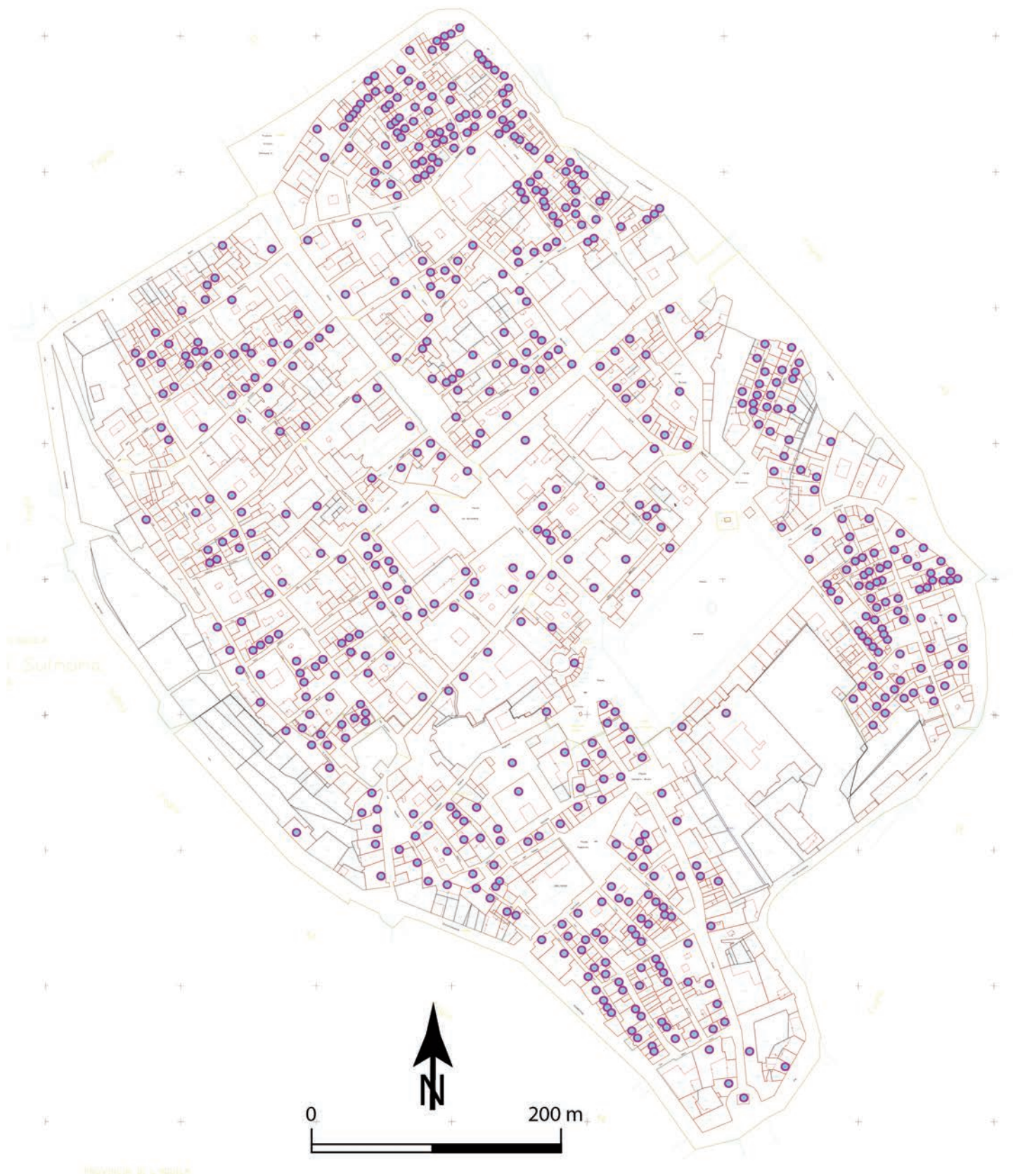
Figura 13 Distribuzione del danno nel centro storico di Sulmona: terremoto del 1933. Figure 13 Damage distribution in the old town centre of Sulmona, due to the 1933 earthquake.
