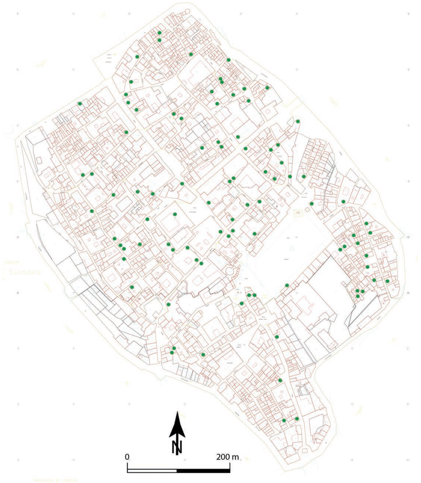
Figura 15 Distribuzione del danno nel centro storico di Sulmona: terremoto del 2009. Figure 15 Damage distribution in the old town centre of Sulmona, due to the 2009 earthquake.
