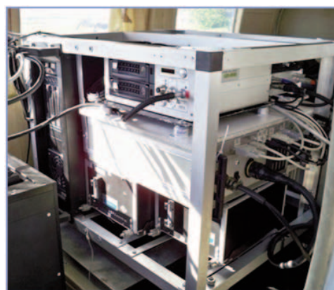
Figure 11 Rack for Computers & Storage units installed on aircraft. Figura 11 Sistema di Storage installato sull'aereo.
