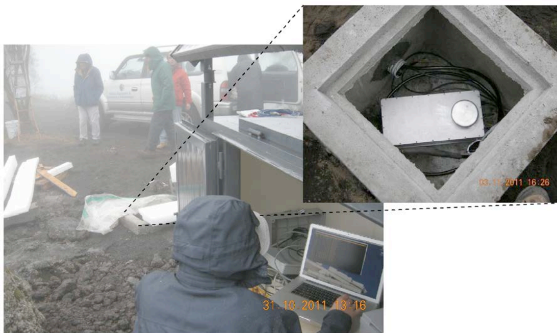
Figura 4. L'aspetto esterno dell'elettronica di controllo (Shoebbox) e la sua tipologia di ubicazione nel sito remoto.
