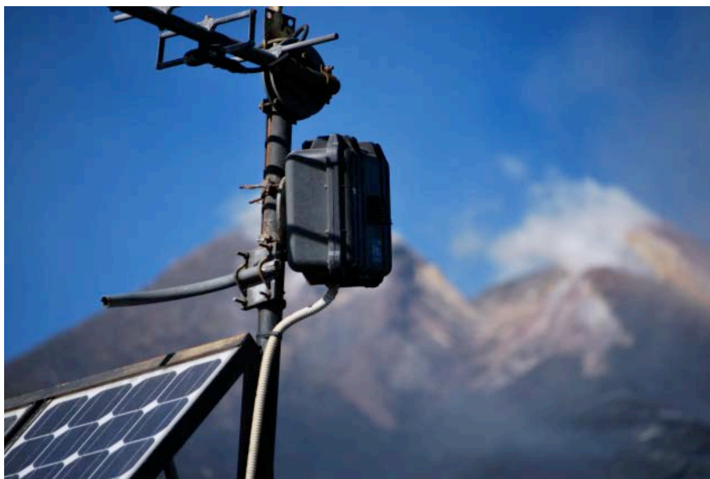
Figura 8. Il radiometro puntato verso il NCSE presso il sito EBEL.
