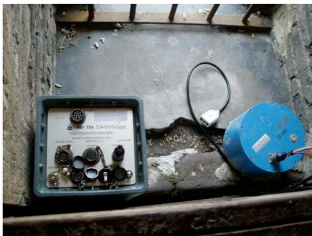
**Figura 2.1** Il sistema di digitalizzazione e il sensore utilizzati nella stazione AS03.
