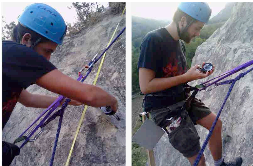
Figura 5. L'operatore mentre si cala ed effettua le misure in sosta sulla parete assicurato con la doppia cordatura.
