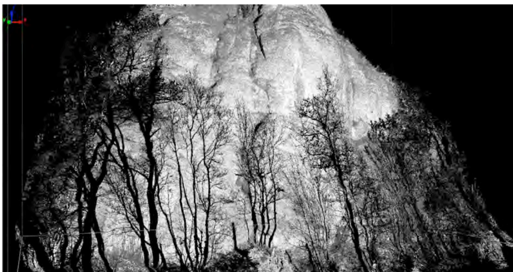
Figura 8. Nuvola di punti della parete acquisita in presenza di una, seppure rada, vegetazione sottostante.
