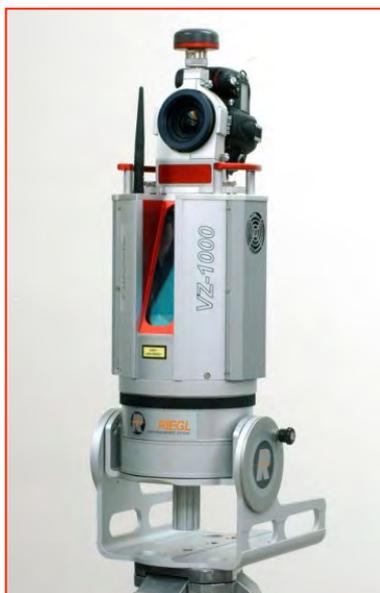
**Figura 8.** Il laser scanner RIEGL VZ1000 utilizzato per i rilievi.
