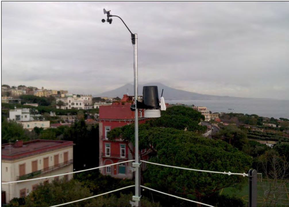
**Figura 58.** Vista d'insieme della centralina meteo (gruppo anemometrico sulla estremità del palo, gruppo termo-igro-pluviometrico a mezza altezza).
