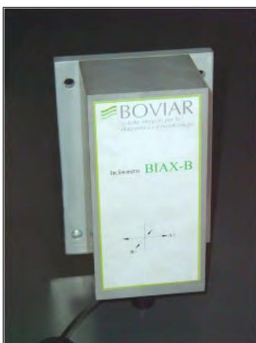
**Figura 48.** Sensore Inclinometrico biassiale per montaggio a parete.
