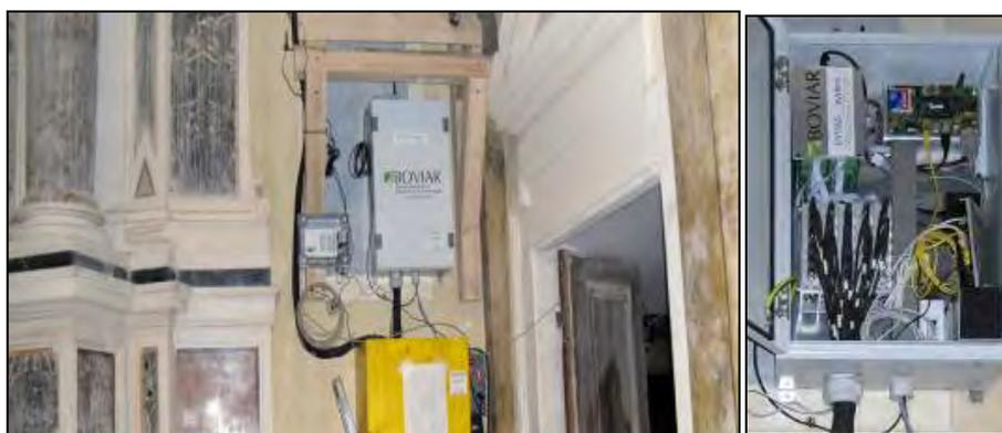
**Figura 55.** Dymas24 *Multichannel* utilizzato nel progetto Chiesa delle Anime Sante a L'Aquila (BOVIAR).
