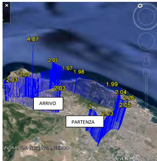
**Figura 7b.** Andamento del CH<sub>4</sub> lungo il percorso C2. In giallo è riportato il valore di concentrazione espresso in ppm.
