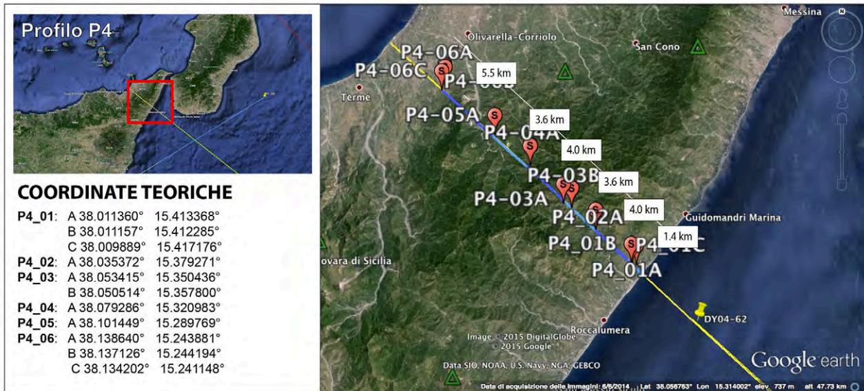
Figura 3. La mappa mostra lo stendimento teorico onshore lungo il proseguimento del profilo DY-04 (vedi Figura 2). Nella legenda a sinistra, le coordinate dei possibili punti da occupare pre-definiti con l'analisi delle foto aeree e mappe geologiche.
