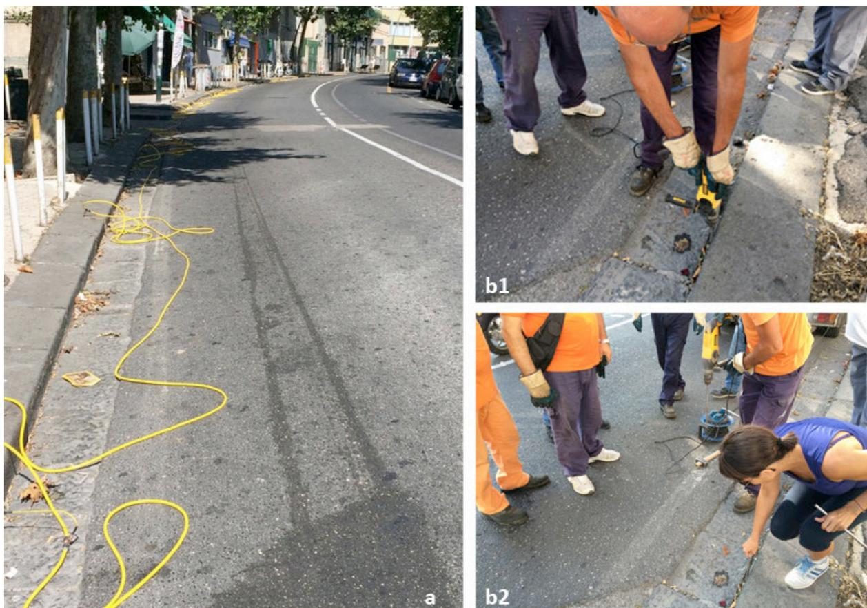
**Figura 4.** (a) Stendimento lungo via B. Cavallino; (b1) foratura e (b2) inserimento elettrodi.
