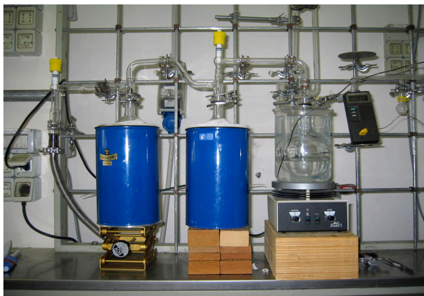
Figura 3. Linea di purificazione in fase di distillazione. Si possono notare le trappole immerse nei dewar di azoto liquido e la termocoppia per il controllo della temperatura.
