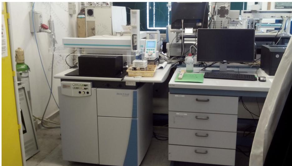
**Figura 4.** Delta V Advantage e GasBench II presenti nei laboratori analitici dell'Istituto di Geofisica e Vulcanologia di Palermo.
