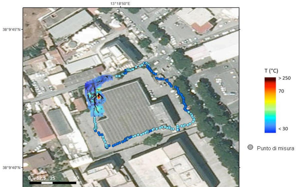
**Figura 7.** Mappa della temperatura rilevata con il pirometro. I punti sul percorso lineare, non idonei per un interpolazione, sono stati rappresentati in modo puntiforme. In alto a sinistra è stato applicato il metodo d'interpolazione Inverse Distance Weighted (IDW).
