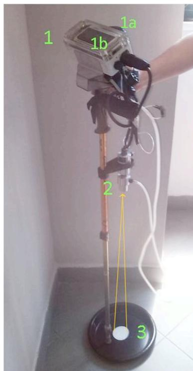
**Figura 2.** Immagine del sistema di rilevamento in assetto di misura: 1 - Unità di controllo contenente il datalogger, l'alimentatore, il sensore di umidità ed il rilevatore di posizione satellitare (GPS); 1a - Antenna del GPS; 1b - Visualizzatore: All'accensione mostra le condizioni dello strumento e durante il rilievo mostra i dati memorizzati nell'ultimo punto; 2 - Corpo del pirometro; 3 - Superficie radiante rilevata alla distanza di 800 mm.
