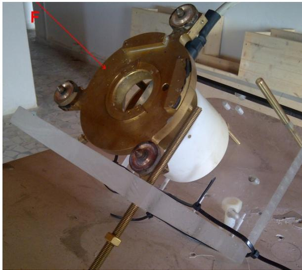
**Figura 6.** a) e b) posizionamento del sensore sulla struttura per la calibrazione.
