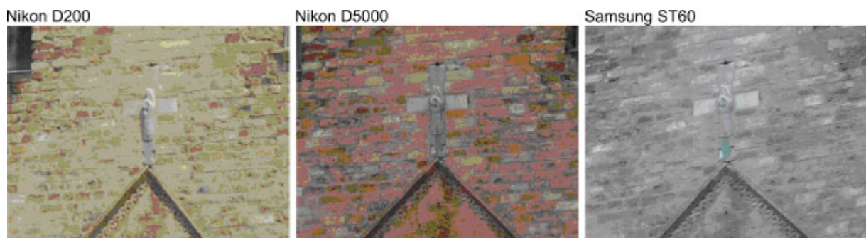
Figura 11. Particolare della facciata della chiesa in immagini acquisite con le tre fotocamere utilizzate per la fotogrammetria SfM.
