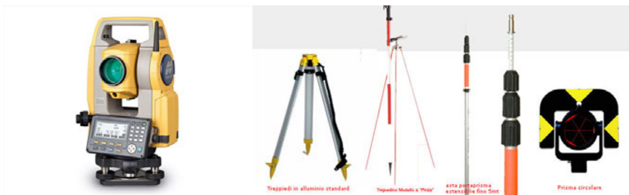
Figura 3. Dispositivi per la misura di distanze a laser da sinistra: stazione totale, treppiedi geodetici, paline e prisma retroriflettore.
