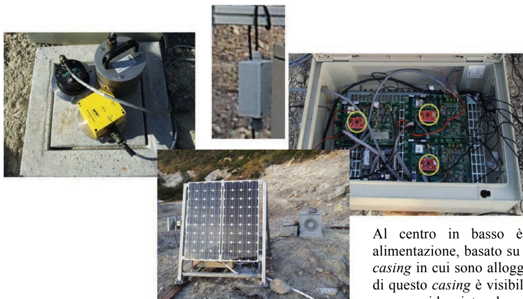
Figura 3. A sinistra, sono mostrati i sensori sismometrici (sismometro a larga banda, accelerometro e sismometro rotazionale) mentre al centro in alto si può vedere il sensore infrasonico (vedi Tabella 2).
