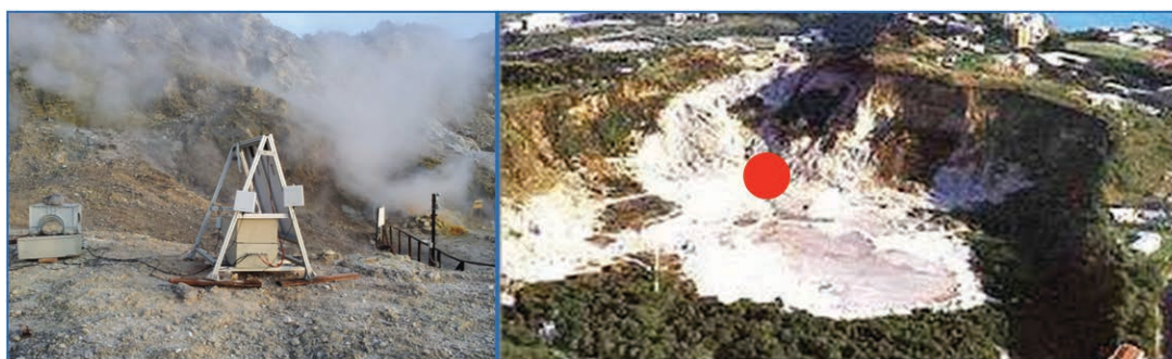
Figura 2. Installazione del sito di acquisizione multiparametrico realizzato con tre datalogger GILDA e sua ubicazione all'interno del cratere del vulcano Solfatara.
