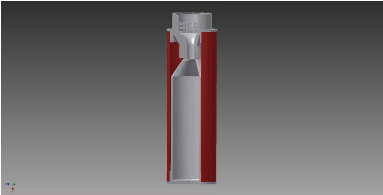
Figura 5. Vista assonometrica del pluviometro assemblato.
