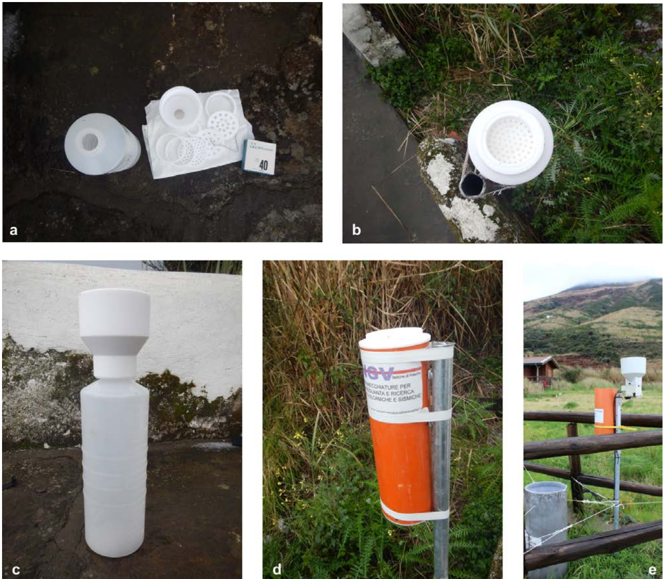
Figura 6. Pluviometro. a) Componenti del pluviometro; b) Vista dall'alto del pluviometro assemblato; c) Vista laterale del pluviometro assemblato; d) pluviometro installato all'osservatorio geofisico dell'Università di Firenze; e) pluviometro installato al COA.
