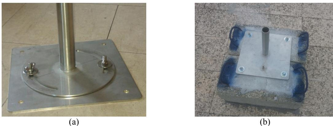
**Figura 4.** Installazione non invasiva di un CR in ambiente urbano e strutture murarie. (a) Base di un CR. (b) Blocco di cemento su cui fissare la base del CR.
