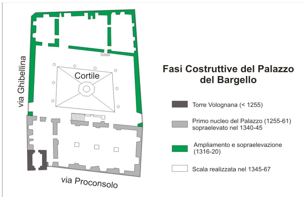
**Figura 1.** Pianta del Palazzo del Bargello e principali fasi costruttive.
