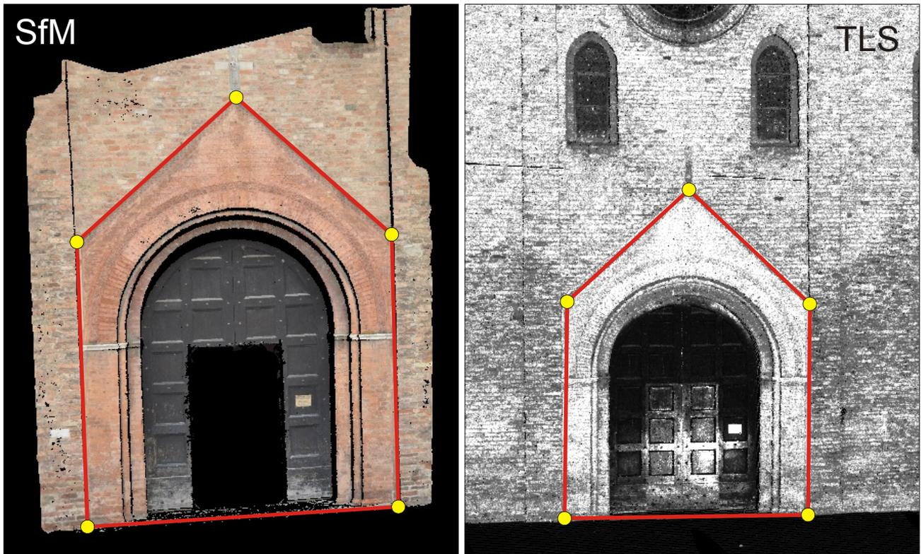
**Figura 5.** Nuvola di punti SfM “TOT” (a sinistra), con scala non reale, e nuvola di punti TLS (a destra), con dati metrici e realistici, su cui sono riportate le polilinee corrispondenti.
