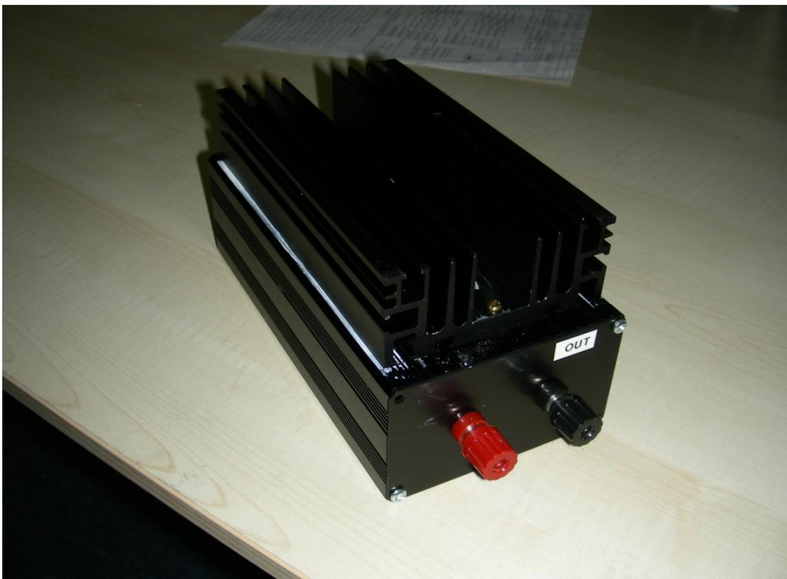
**Figura 1.** Il regolatore di carica per pannelli solari.
