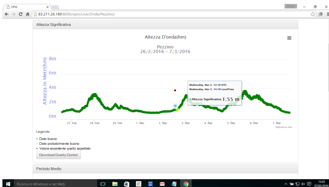
Figura 36b. Effetto dell'arrivo delle onde S sul dato ondametrico a Pezzino.
