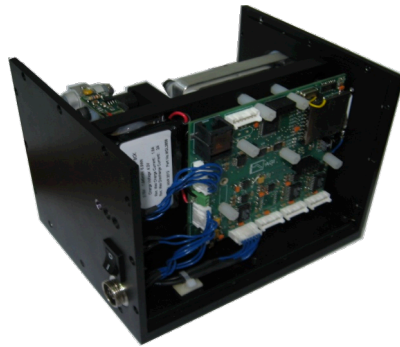
Figura 15. Vista interna dell'accelerometro AGI.
