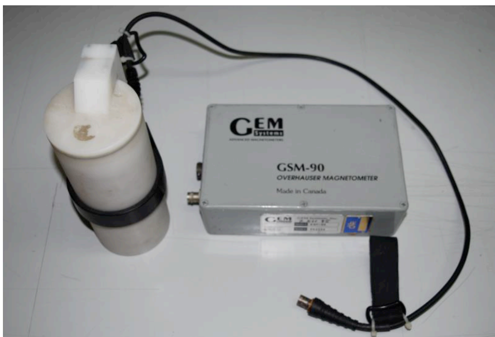
Figura 1. Magnetometro GSM90 (versione del 1997) commercializzato dalla Gem Systems, ed ancora installato in alcuni siti sul M.te Etna.
