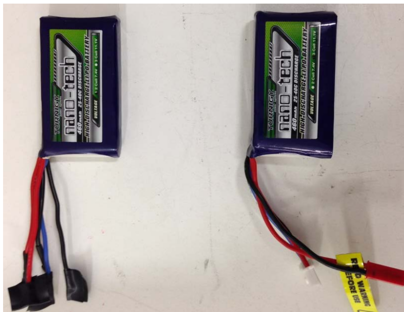
Batteria sistema di terra (a sinistra) e batteria sistema di bordo (a destra)
