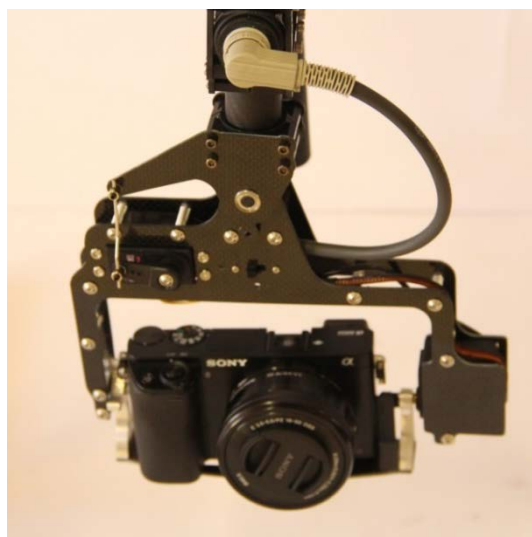
Fotocamera Sony A 6000 con gimbal mobile su due assi
