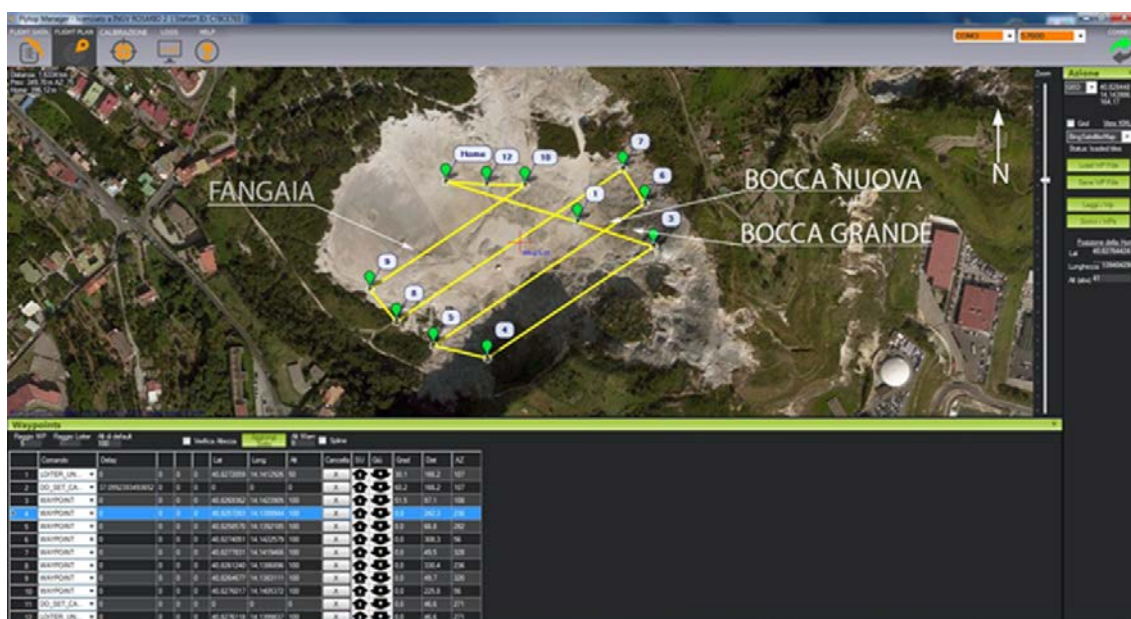
Figura 4. Missione di volo programmata nel Cratere de La Solfatara, tramite software FlyTop Manager .
