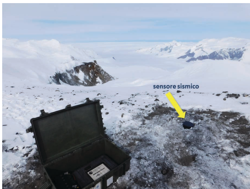
Figura 8. La stazione RITT2 con in evidenza il posizionamento del sensore. Sullo sfondo la parete fumarolizzata del cratere del M. Rittmann (credits Andrea Cannata, ©PNRA).
