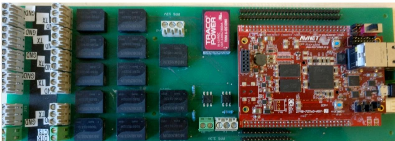
**Figura 8.** Scheda per la gestione dell’FPGA e delle linee RS-232 degli strumenti.
