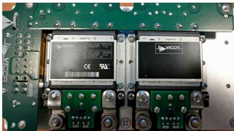
**Figura 4.** Vipac Array con uscita a 48 V.
