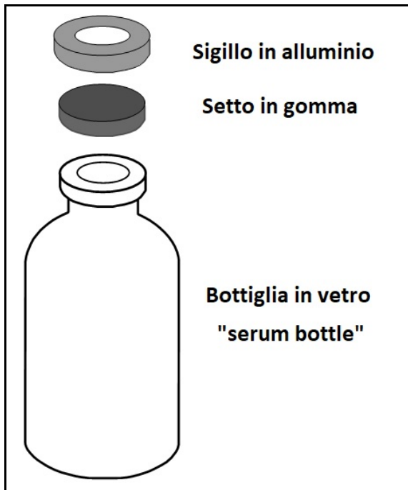
Figura 5. Schema della tipologia di contenitore utilizzato. Le bottiglie in vetro pyrex, denominate commercialmente "serum bottle". I recipienti sono stati sigillati tramite crimpatrice con un sigillo in alluminio a ricoprire un setto di gomma adatto ad essere bucatto con un ago e capace a mantenere sovrappressioni di alcune centinaia di millibar.
