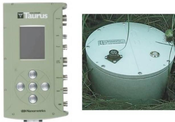
**Figura 5.** Strumentazione utilizzata: stazione digitale Nanometrics Taurus, (a sinistra) e sensore *broadband* a tre componenti Lennartz LE-3D 20 sec (a destra).
