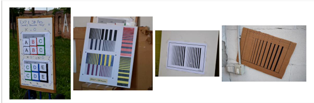
Figura 2. Le prime tre immagini mostrano i primi target rivelatisi non adatti all'esperimento. La carta (o il cartone trattato) è troppo liscio e luminoso e le analisi hanno portato a risultati scadenti e non utilizzabili. La quarta immagine invece è un target semplice di cartone grezzo su cui sono stati colorati dei rettangoli delle dimensioni volute ed è stato utilizzato per la fase iniziale di questo esperimento.
