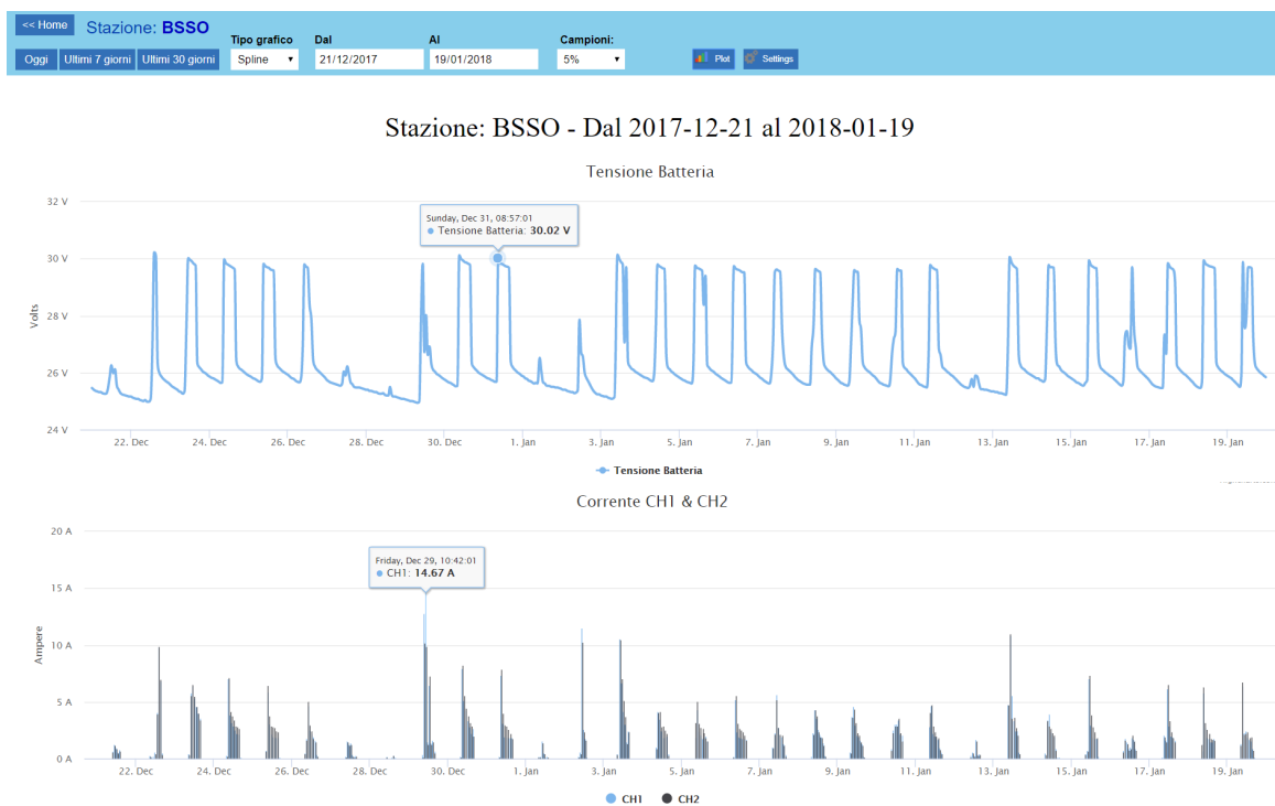
Figura 19. Grafico tensione batteria e corrente di carica.
