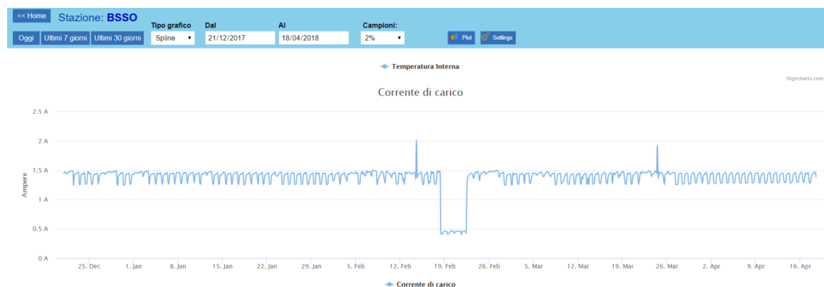
Figura 20. Grafico corrente di carico della stazione di BSSO.
