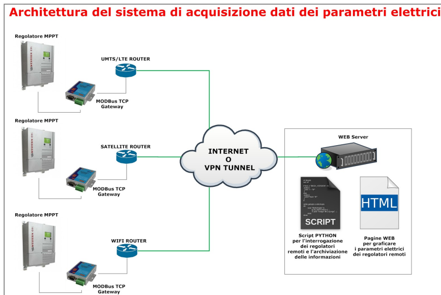
Figura 12. Architettura software sistema di acquisizione valori elettrici.
