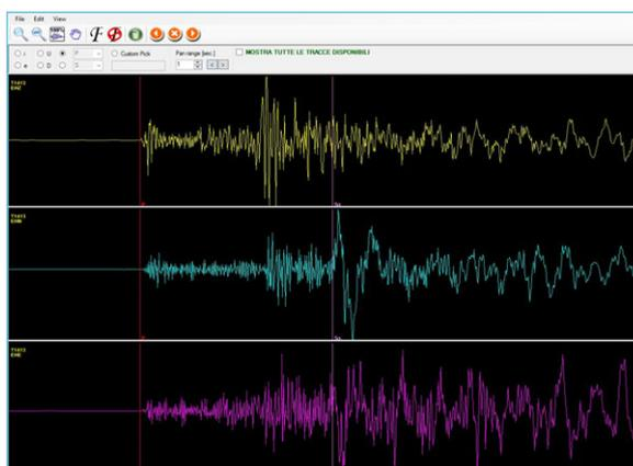
**Figura 10** Esempio di una fase S convertita in P (SP) alla stazione T1413. Sui sismogrammi è riportata la lettura delle fasi P (in rosso) ed S (in rosa). L'aumento di ampiezza che precede la fase S, specialmente evidente sulla componente verticale in alto, è la convertita SP.
